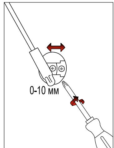
Открывание и закрывание двери может быть отрегулировано позицией лифта в креплении к боковине:
